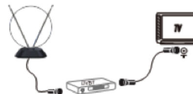
(рис. 2) Подключение через DVB-T2 приемник
