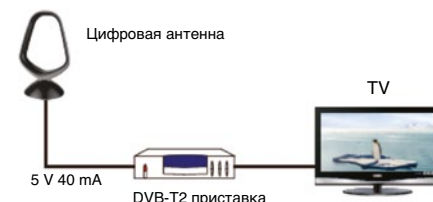
Рис. 1. Питание через цифровую телевизионную приставку
