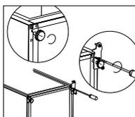
6. Открутите и снимите болт нижней дверной петли. Затем поверните крепеж, как показано на схеме, и закрепите его с помощью того же болта.
