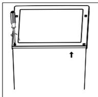
3. Снимите крышку и положите ее на ровную, гладкую поверхность.
