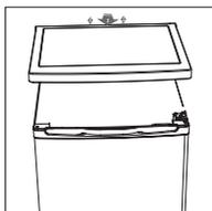
4. Выкрутите винты верхней петли и снимите ее, снимите дверь и положите ее на ровную, гладкую поверхность.
