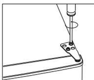
5. Выкрутите винты нижней петли и снимите ее. Отсоедините регулируемые ножки с обеих сторон.
