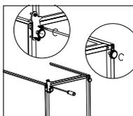
8. Отделите дверной уплотнитель и поверните его, как показано на схеме.
