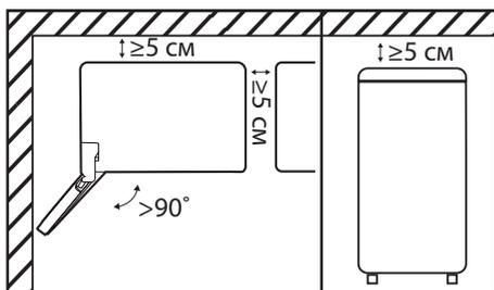
При установке морозильного шкафа боковой стороной к стене помещения предусмотрите наличие достаточного пространства для открывания дверей на угол более 90 градусов. Сверху, с задней и боковых его сторон должно быть свободное пространство не менее 5 см (для более подробной информации обратитесь к разделу «Установка»).
