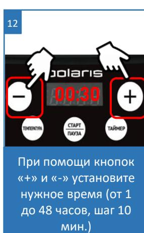
При помощи кнопок «+» и «-» установите нужное время (от 1 до 48 часов, шаг 10 мин.)
