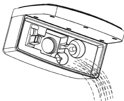
**Нельзя выливать воду из поддона таким образом, иначе можно повредить внутреннее устройство прибора:**
