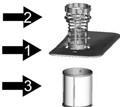
Система фильтров состоит из фильтра грубой очистки, плоского (основного) фильтра и микрофильтра (фильтра тонкой очистки).
