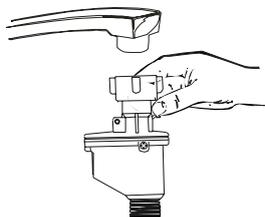
Прибор должен быть подключен к водопроводу с помощью нового комплекта шлангов.
