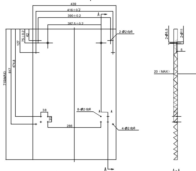
**2** Установить крюк на декоративную деревянную панель и поместить крюк в паз на наружной дверце посудомоечной машины (см. рис. 4а). После размещения панели закрепить панель на наружной дверце с помощью винтов и болтов (см. рис. 4b) .
