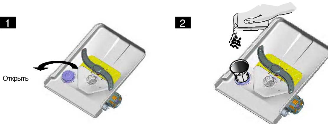
**А** Извлечь нижнюю корзину, а затем отвинтить и снять крышку с контейнера соли. **1**
