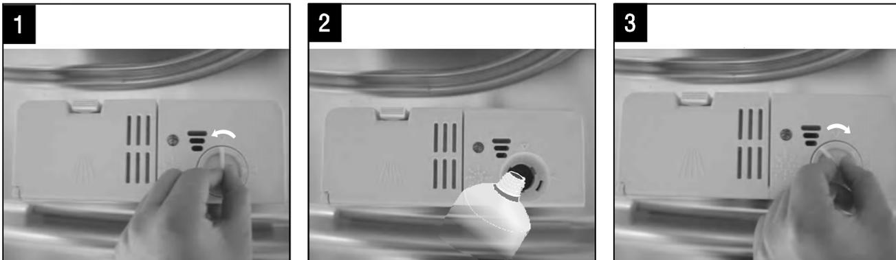
**1** Чтобы открыть устройство распределения, повернуть крышку в направлении стрелки "открыто" (влево), а затем поднять и вынуть крышку.
