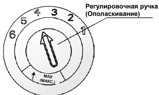
Дозатор ополаскивателя имеет шесть или четыре положения режима работы. Всегда начинайте мытье посуды, когда ручка установлена в положение "4". Если возникают проблемы с образованием на посуде пятен и плохим высыханием, увеличьте подачу ополаскивателя, переведя ручку регулятора в положение "5". Если это не помогает, установите ручку в еще более высокое положение. Рекомендуемая установка "4". (На заводе установлено "4").
