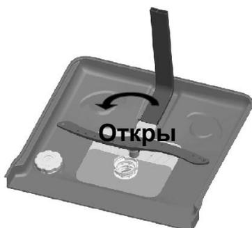
Операция 1: Поверните фильтр против часовой стрелки,
