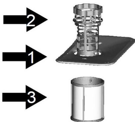
Система фильтрации состоит из фильтра грубой очистки, плоского (основного) фильтра и микрофильтра (фильтра тонкой очистки).
