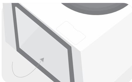
**1** Наклоните машину и зафиксируйте на мягкой опоре.
