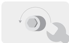
Ослабьте все четыре транспортировочных болта с помощью гаечного ключа.
