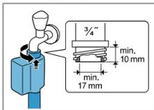
2. Осторожно откройте водопроводный кран и проверьте места соединения на наличие утечек.
