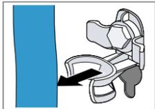
2. С помощью гаечного ключа SW13 отвинтите все 4 транспортировочных болта ① и ② снимите их.
