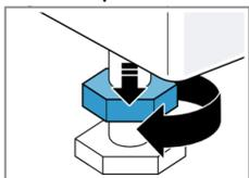
2. Чтобы выровнять устройство, поверните ножки устройства. Проверьте настройку спиртовым уровнем.
