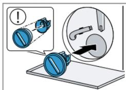
5. Закрутите крышку насоса до упора.
