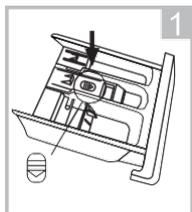
Нажмите на фиксатор и извлеките выдвижной отсек для моющих средств
