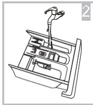
Промойте ящик для моющ. средств и крышку под водой
