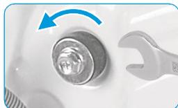
Ослабьте 4 транспортировочных болта с помощью гаечного ключа.
