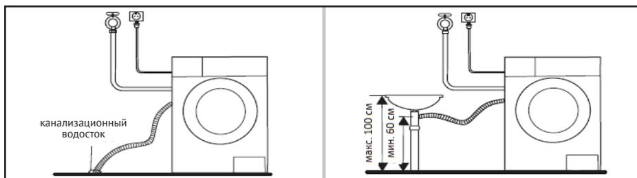
Гофрированный сливной шланг должен быть подключен к сливу на высоте 60-100 см от пола.
