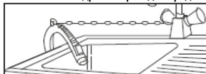
Если в качестве слива используется раковина, гофрированный сливной шланг должен быть расположен над отверстием перелива для предотвращения скопления воды. Для более надежного крепления на борту раковины используйте
