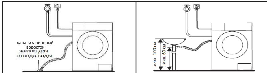
Гофрированный сливной шланг должен быть подключен к сливу на высоте 60-100 см от пола.
