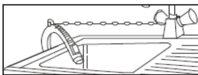
Если в качестве слива используется раковина, гофрированный сливной шланг должен быть расположен над отверстием перелива для предотвращения скопления воды. Для более надежного крепления на борту раковины используйте изогнутый держатель.
