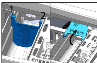
В случае, когда используется жидкое моющее средство, установите и опустите вниз разделитель. Затем, залейте жидкое средство для стирки по уровню в отделение обозначенное символом II. **При использовании стирального порошка поднимите разделитель вверх.**
