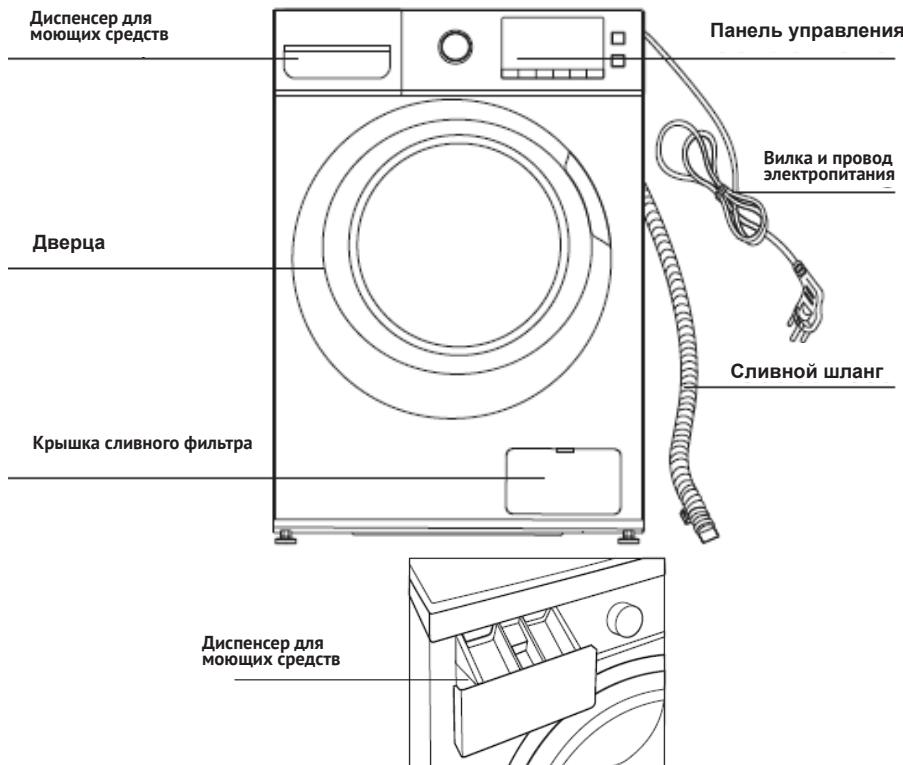
(Изображение имеет справочный характер и может отличаться от реального прибора.)
