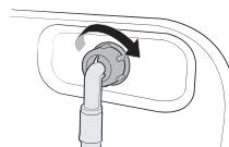
Присоедините другую сторону шланга к заливному клапану и затяните без помощи инструмента.
