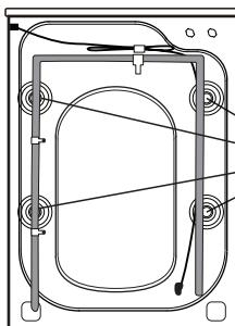
Открутите 4 болта на задней стенке и извлеките 4 транспортировочные втулки. Закройте 4 отверстия специальными заглушками из комплекта стиральной машины.
