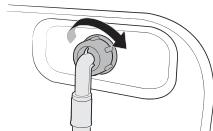
Присоедините другую сторону шланга к заливному клапану и затяните без помощи инструмента.
