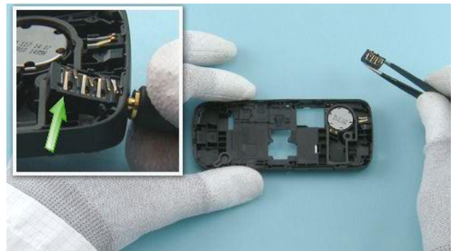
22) Use an AV plug to lift up the AV JACK. Remove the AV JACK with tweezers.
