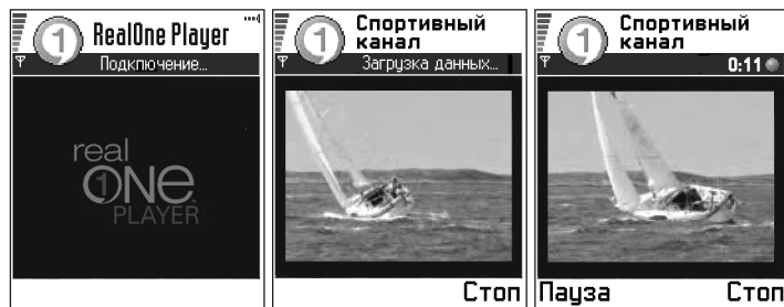
Рис. 3 Поточное воспроизведение мультимедийного файла из сети Интернет: подключение, буферизация, затем воспроизведение
