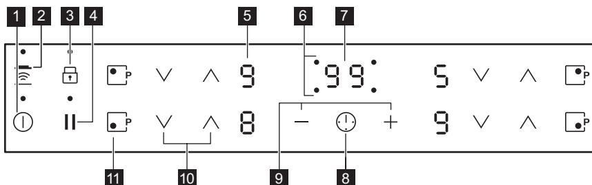
K ovládání spotřebiče používejte senzorová tlačítka. Displeje, ukazatele a zvukové signály signalizují, jaké funkce jsou zapnuté.
