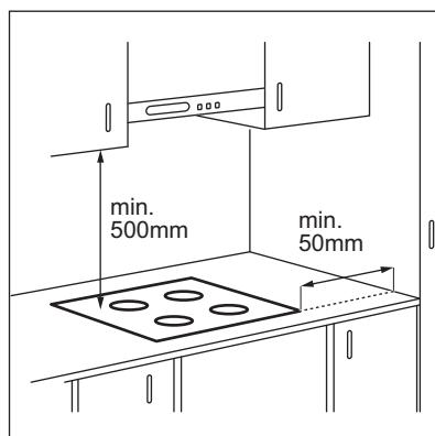
В случае установки прибора над выдвижным ящиком система вентиляции варочной панели может во время
