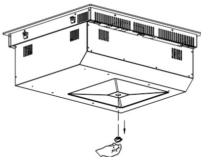
Если в прибор случайно попало большое количество жидкости, снимите силиконовую пробку на нижней части корпуса, чтобы слить жидкость.
