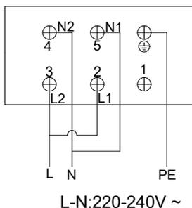
Схема подключения проводников шнура питания к клеммной коробке варочных поверхностей H1BH 68980 NB и H1BH 84980 NB.
