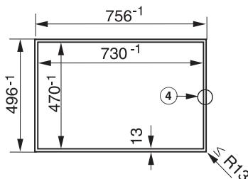
④ Ступенчатая фрезеровка
