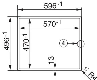
④ Ступенчатая фрезеровка
