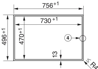
④ Ступенчатая фрезеровка
