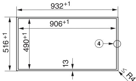
④ Ступенчатая фрезеровка
