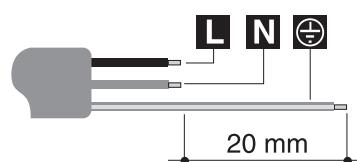
В случае замены кабеля электропитания сечение проводов нового кабеля должно быть не менее  $0,75 \text{ mm}^2$  (кабель 3 x 0,75), при этом помните, что на конце подключения прибора провод
