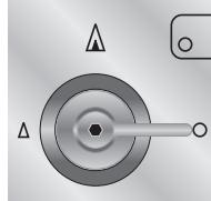
В моделях с предохранительными клапанами для розжига придержите ручку нажатой несколько секунд, чтобы позволить термопаре разогреться. Может случиться так, что в момент отпускания ручки конфорка погаснет: это означает, что термопара недостаточно нагрелась.
