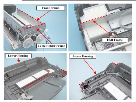
Figure 4-9. Sharp Metal Edges
