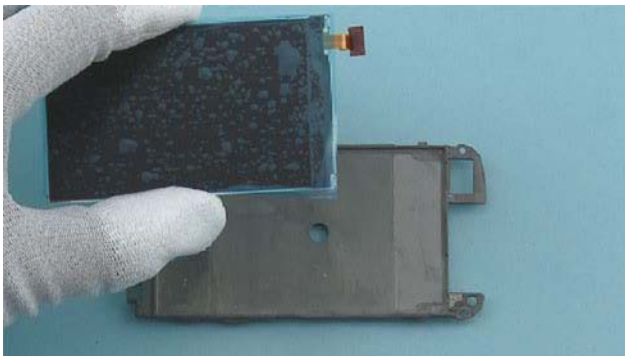
21) Separate the DISPLAY and the UI FRAME.
