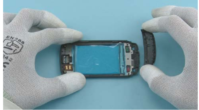
32) Remove the A-COVER DECO.
