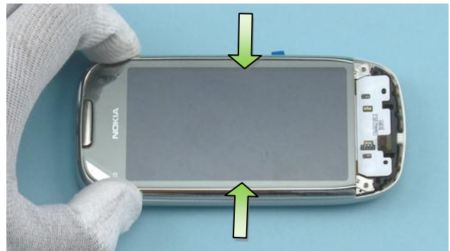
53) Press the A-COVER from the sides.
