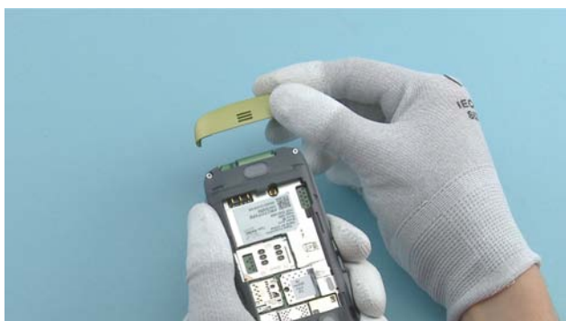
9) Remove the BOTTOM CAP .
