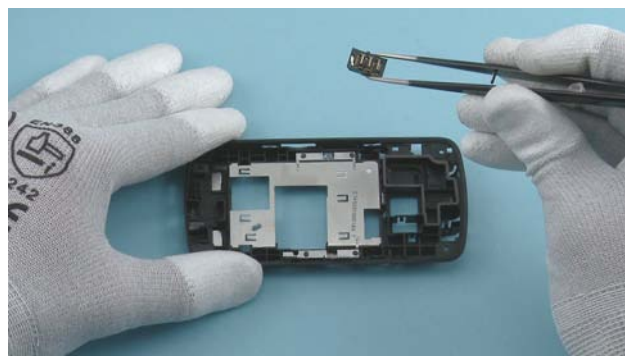
44) Remove the AV JACK with the tweezers.
