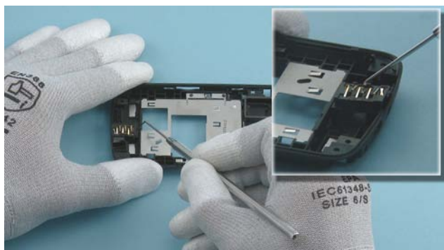
43) Use the dental tool to lever up the AV JACK.
