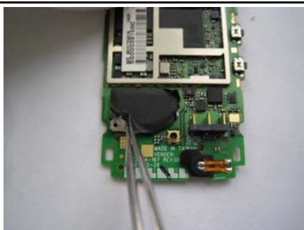
15. Tear off the mylar.
