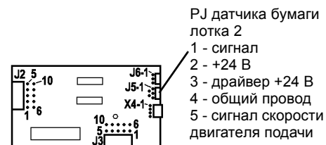
Рисунок 5 PWB управления лотка
