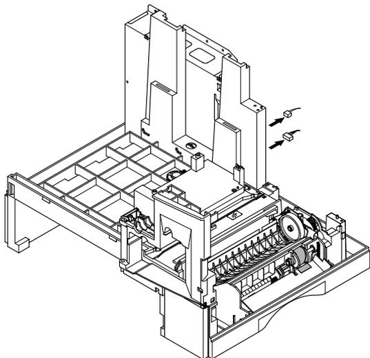
3. Удалите винт и снимите ложный корпус.
