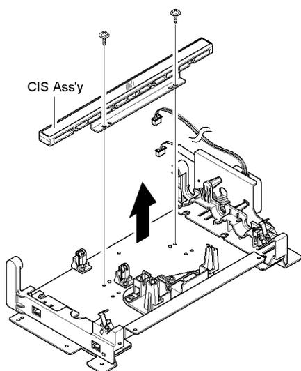
9. Удалите винт, крепящий держатель CIS и извлеките узел.
