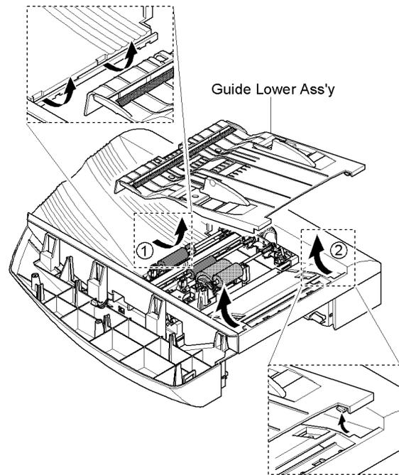
4. Потяните входной лоток в направлении стрелки и вытащите его.
