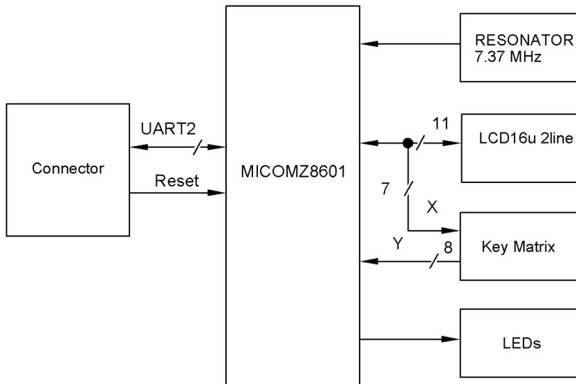
Блок-схема панели управления
