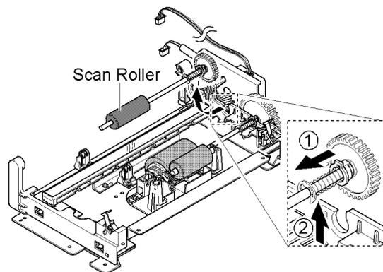
6. Освободите защелку ролика ADF с шестерней, и вытащите узел.
