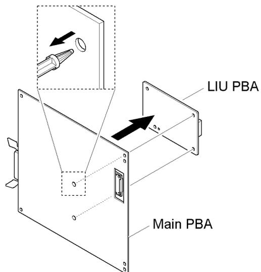
2. Удалите пять винтов и снимите главную плату с главного нижнего экрана.
