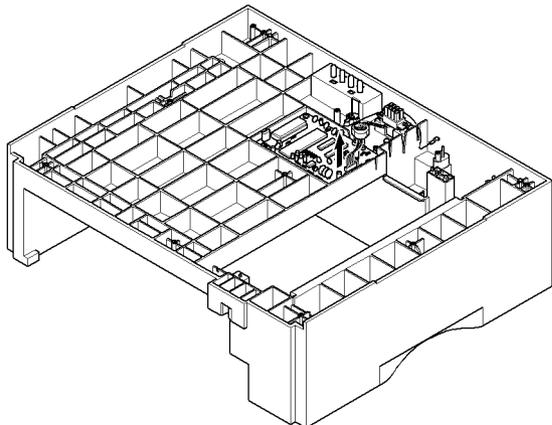
12. Удалите винт, крепящий заземляющий кабель. Снимите кабель с заземляющей пластины.
