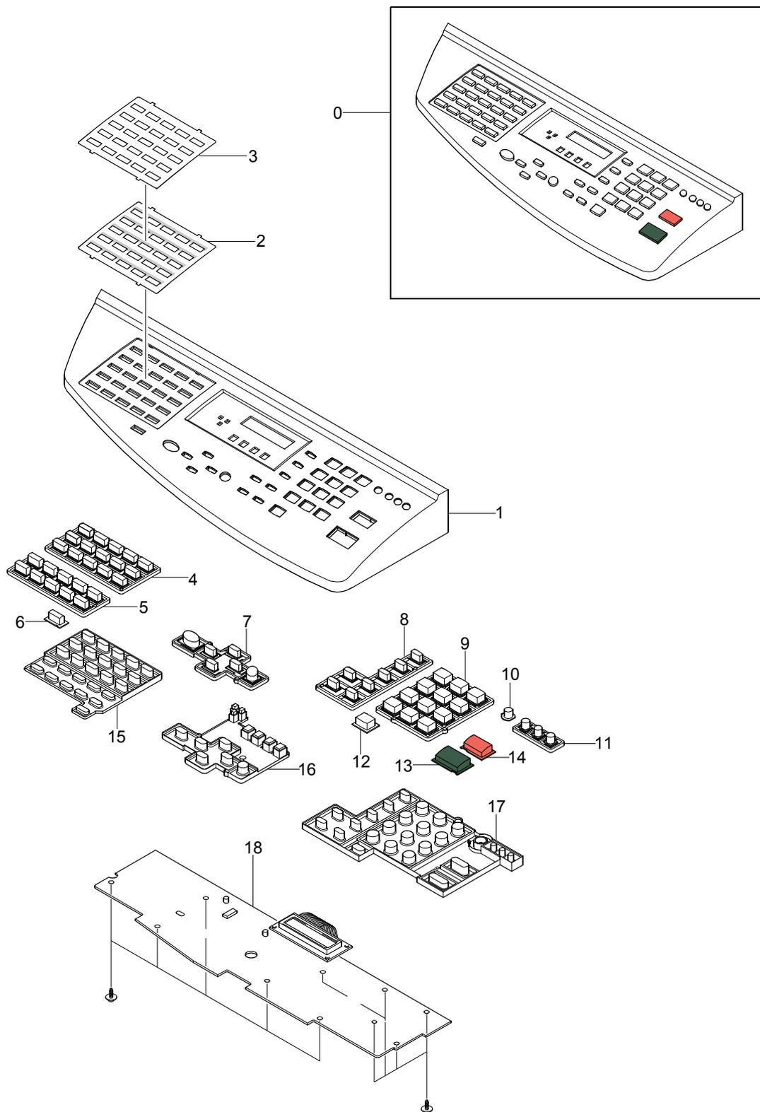
**8-18-1 Список частей узла панели управления (FaxCentre F12)**
