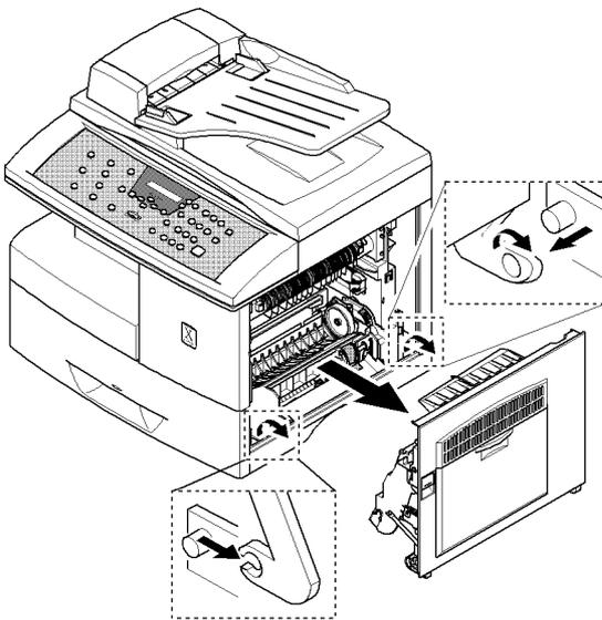
3. Освободите защелку передней части, фиксирующей крышку на раме, и снимите крышку.
