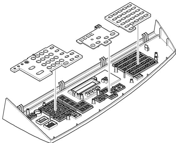
7. Снимите клавишную панель.
