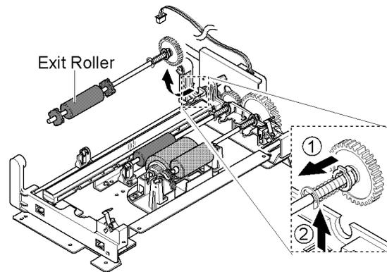
5. Освободите защелку ролика сканера с шестерней, и извлеките узел, как показано ниже.
