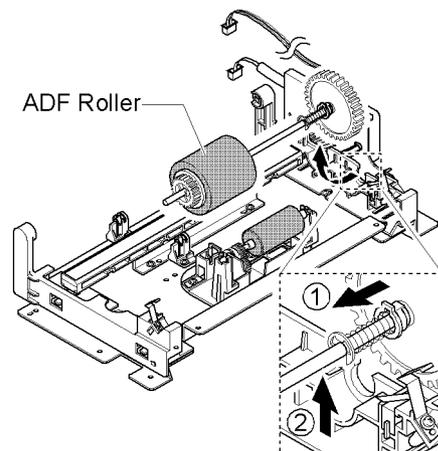
7. Потяните обе боковые стенки и извлеките ролик захвата, как показано ниже.
