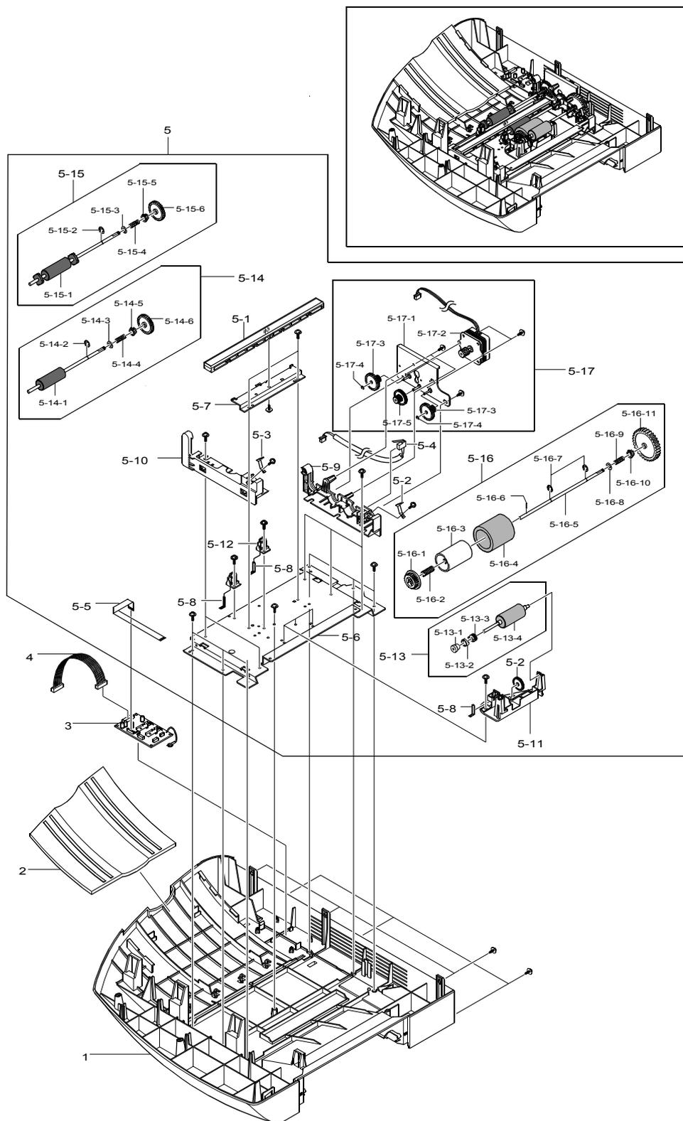
**8-17-1 Список частей нижнего узла сканера (FaxCentre F12)**
