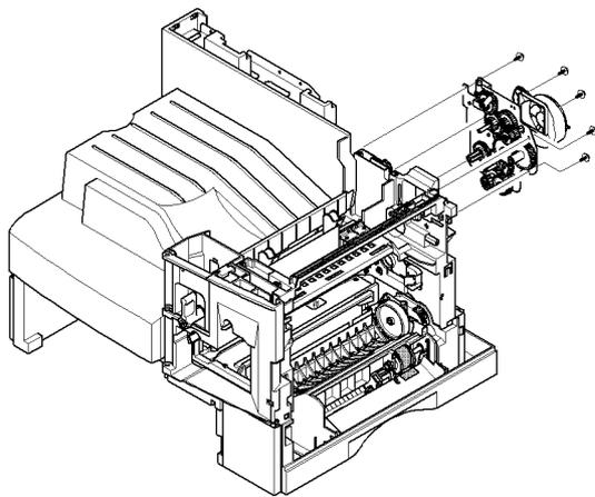
4. Удалите винт, и снимите вентилятор и пылесборник.
