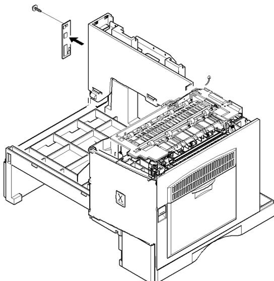
2. Удалите винт и снимите заднюю крышку узла выдачи, как показано ниже.
