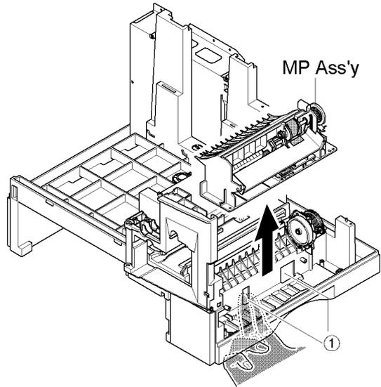
2. Удалите четыре винта и извлеките ложный корпус.
