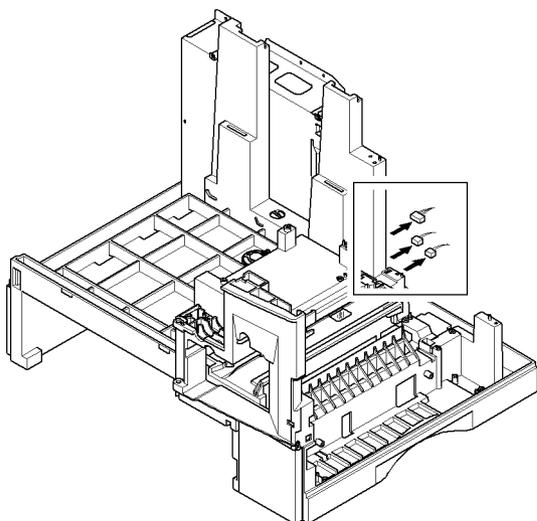
2. Удалите два винта и извлеките рельсовую направляющую кассеты.
