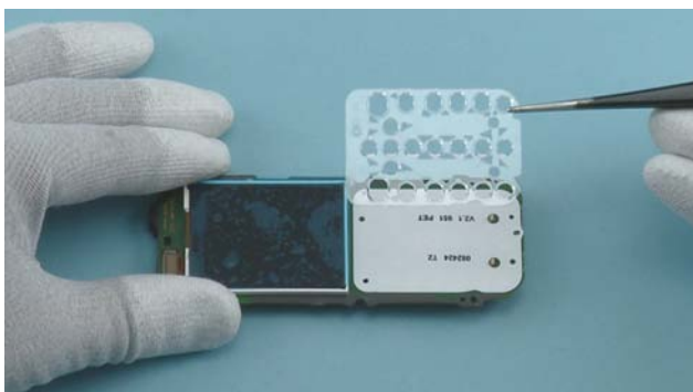
29) Remove the LIGHT GUIDE.
