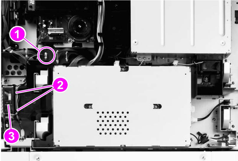
**Figure 90.** Power-supply fan
