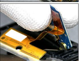
MAKE SURE THE PBA KEY FLEX FLIP COMPLETE IS PROPERLY ALIGNED AS THE PICTURE SHOWS!
