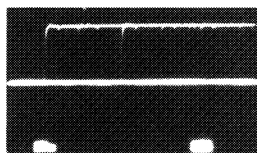
21. IC601 Pin 21 (E-PCB) S D A 4.8V, 20 \mu s / Div
