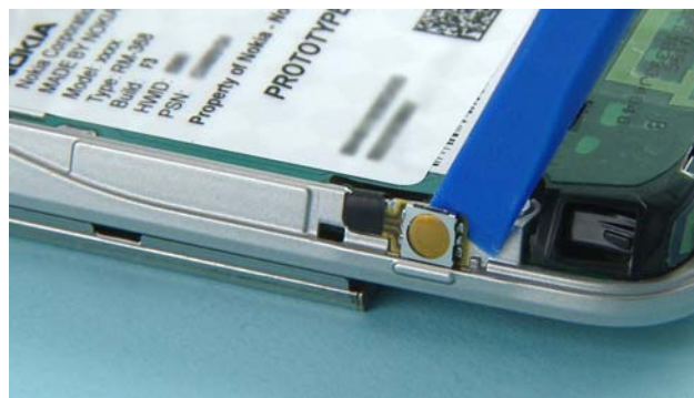
18) Use the SS-93 to detach the camera button.
