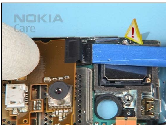
23. Open the AV FLEX connector and remove the AV FLEX ASSEMBLY.
