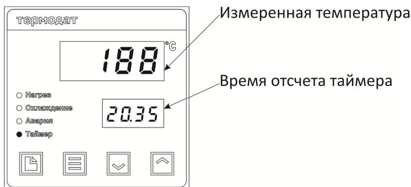
Рисунок 4 - Внешний вид прибора с включенным таймером
